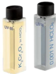
schen Genauigkeit im sichtbaren Spektralbereich. Hellma Analytics bezieht das Referenzmaterial für diese Filter direkt vom NIST (SRM® 935a „Potassium Dichromate“). Die Filterlösungen werden streng nach Vorgaben des NIST hergestellt, unter kontrollierten Bedingungen abgefüllt, unverzüglich abgeschmolzen und damit luftdicht und dauerhaft verschlossen.
